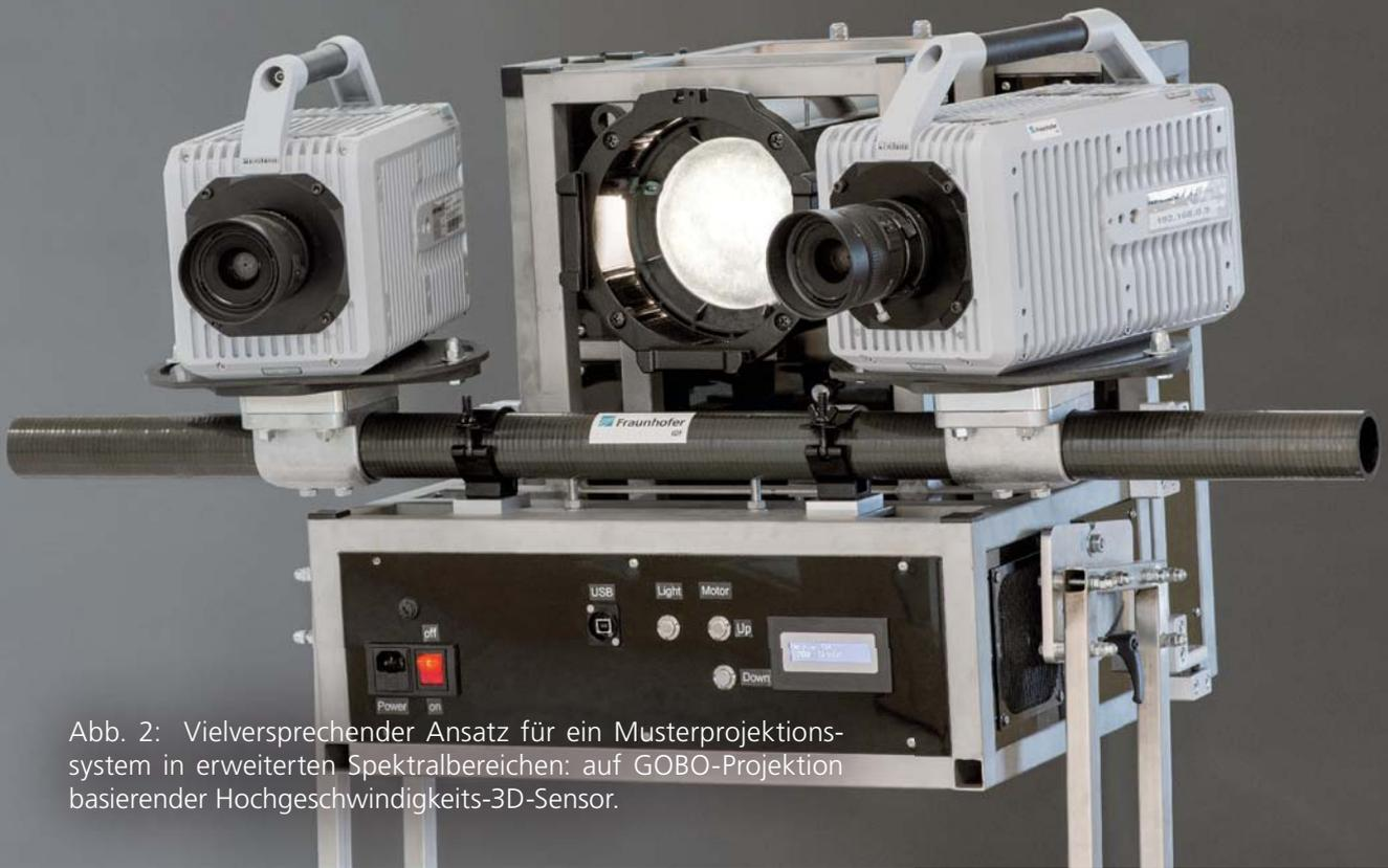
Abb. 2: Vielversprechender Ansatz für ein Musterprojektionssystem in erweiterten Spektralbereichen: auf GOBO-Projektion basierender Hochgeschwindigkeits-3D-Sensor.
