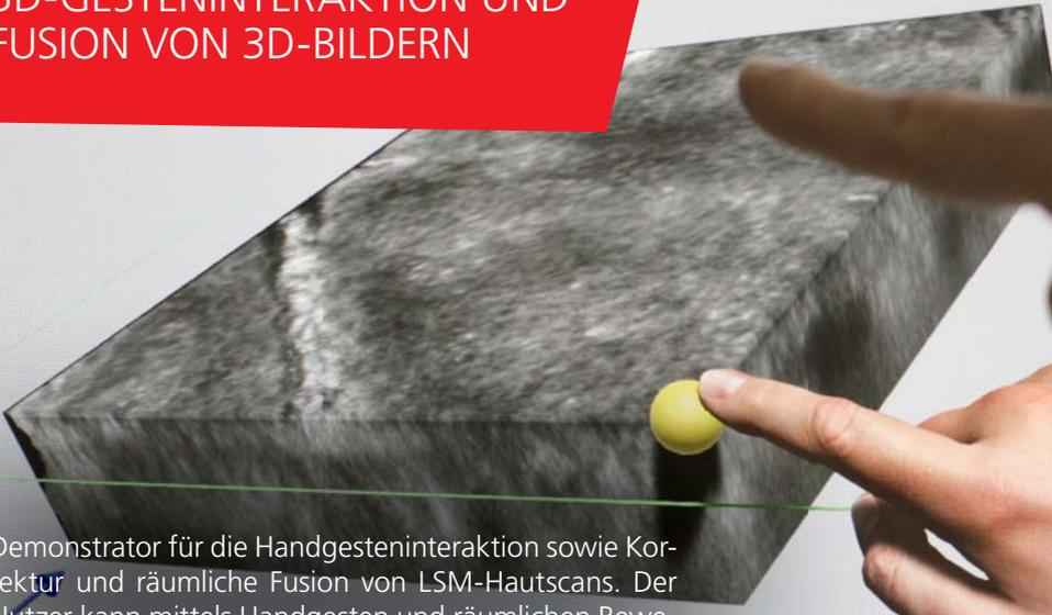
Demonstrator für die Handgesteninteraktion sowie Korrektur und räumliche Fusion von LSM-Hautscans. Der Nutzer kann mittels Handgesten und räumlichen Bewegungen das 3D-Objekt manipulieren.
