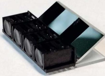
Komplettbau des flachbauenden, zeilenförmigen Multiaperturobjektivs.
