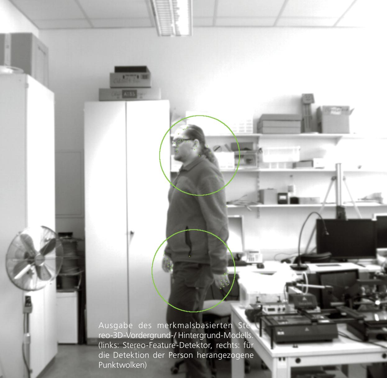
Ausgabe des merkmalsbasierten Stereo-3D-Vordergrund-/Hintergrund-Modells. (links: Stereo-Feature-Detektor, rechts: für die Detektion der Person herangezogene Punktwolken)
