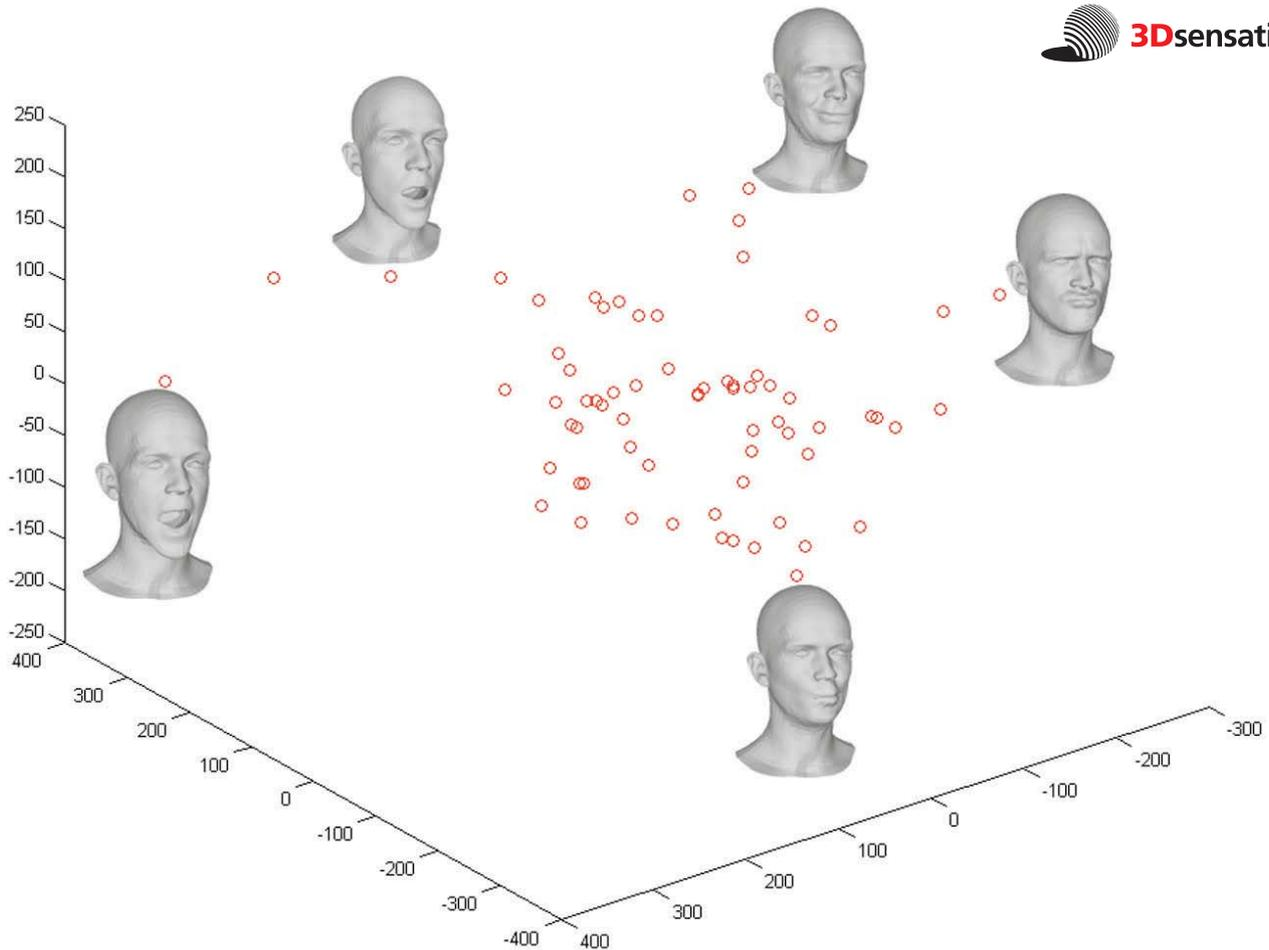
Vereinfachte Darstellung möglicher Gesichtsausdrücke einer Person. Mithilfe statistischer Verfahren kann aus einer Trainingsdatenbank angepasster Template-Modelle ein niedrigdimensionaler Raum möglicher Gesichtsausdrücke extrahiert werden. Basierend auf der niedrigdimensionalen Repräsentation können weitere Verfahren zu Interpolation oder Klassifikation von Gesichtsausdrücken angewandt sowie Modelle zur 3D Rekonstruktion gelernt werden.
