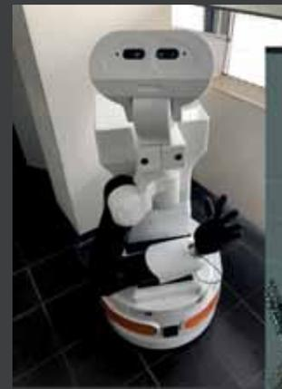
Mobiler Roboter mit u.a. RGB-D-, Sonar- und Laser-Sensorik, sowie Mikrofon und Lautsprechern. Dazu ein Greifarm mit 5 Fingerhand. Zur Orientierung in einer unbekanntem Umgebung wird ein SLAM-Verfahren angewendet, welches aus den Eingangsdaten der Sensorik eine Umgebungskarte erzeugt und gleichzeitig den Roboter in dieser lokalisiert.
