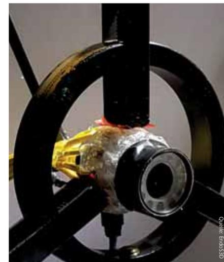
Abb. 4. Mit Fasern verbundener Messkopf in einer Dreipunkthalterung. Die auf der Achse befindliche Miniaturkamera ist außen von einer ringförmigen Streuscheibe umgeben, die von 10 Fasern beleuchtet wird.
