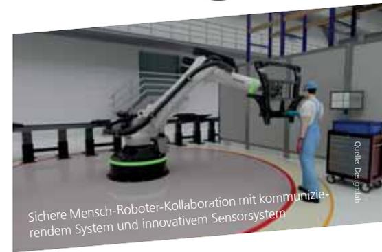
Sichere Mensch-Roboter-Kollaboration mit kommunizierendem System und innovativem Sensorsystem
