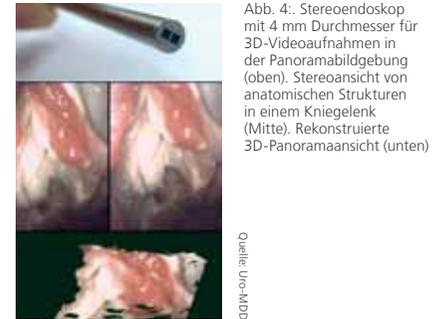
Abb. 4: Stereocystoskop mit 4 mm Durchmesser für 3D-Videoaufnahmen in der Panorambildgebung (oben). Stereoansicht von anatomischen Strukturen in einem Kniegelenk (Mitte). Rekonstruierte 3D-Panoramaansicht (unten)
