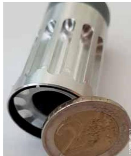
Abb. 3. Prinzipieller Aufbau der Messkopfhaltung (ohne Fasern) im Vergleich mit einer 2€ Münze (Durchmesser 2,5 cm).
