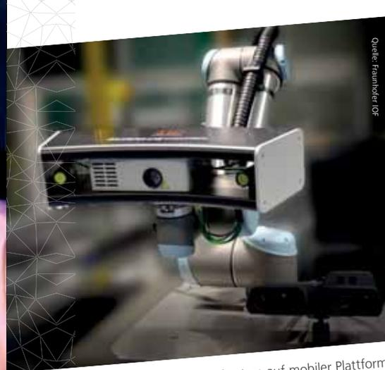
Abb. 2: Interaktives Prüfsystem auf mobiler Plattform mit einem Sensor für die Erkennung der Lage des Prüfteils und des Fingerzeigs sowie einem zweiten Sensor für die Prüfung des Prüfteils.
