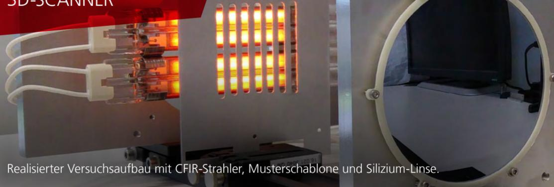
Realisierter Versuchsaufbau mit CFIR-Strahler, Musterschablone und Silizium-Linse.
