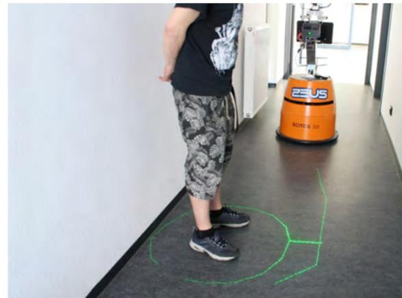
Laserprojektion einer Personenhypothese mit geschätzter Oberkörperorientierung (orientierter Kreis) und geplante Trajektorie des Roboters als Linienzug.
