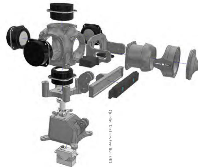
Explosionsdarstellung des Vortexgenerators, der Sensor und -Ansteuereinheit in senkrechter Konfiguration
