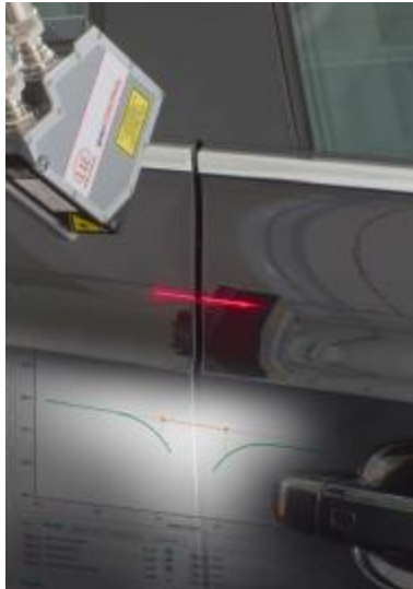
Abbildung 4: Messung an realem Target (Spalt)
