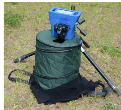
Abbildung 3: Aufnahme einer Schuhspur (links: Transportkoffer, mitte: handgehalten, rechts: stativgehalten mit Abschattungsbox)
