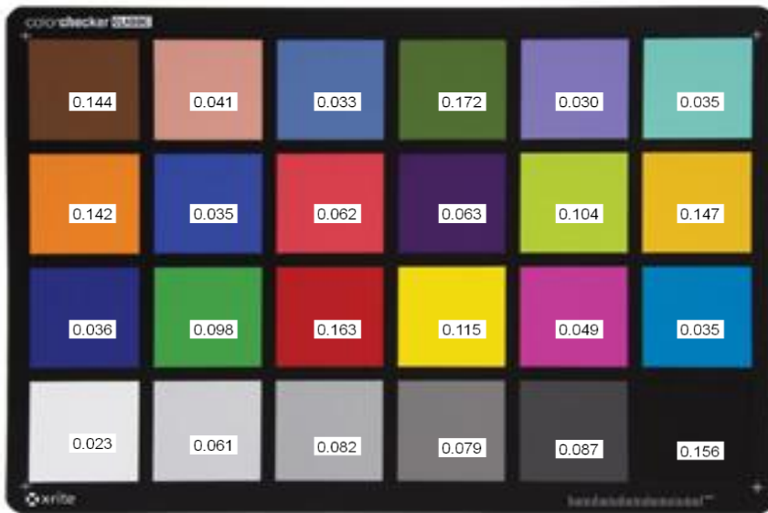
Abbildung 6: Räumliches Rauschen an farbigen Oberflächen
