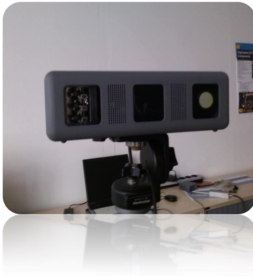
Abbildung 1: Industrial 3D Scanner mit diffraktiver Musterprojektion
